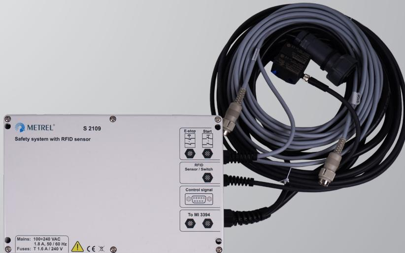
Dieses Sicherheitsmodul ist für Testplätze mit Schutzabdeckungen oder Schutztüren vorgesehen. Dieses Modul ist für den Schutz mit einem RFID-Sensor und Notschalter vorgesehen. Der RFID-Schalter gibt den Zustand (geöffnet/geschlossen) der Tür des Gehäuses oder Schrankes an. Wenn die Tür geöffnet wird, trennt das Sicherheitsmodul die Messkreise vom Netz, sodass der Bediener optimal geschützt ist. Das Sicherheitsmodul ist zudem mit einem Notschalter und einer START-Taste ausgestattet.
